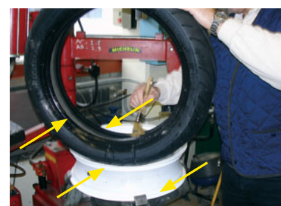
Fig. 1 : Lubrification du pneu et de la jante.
