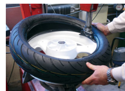
Fig. 2 : Installation du premier bourrelet.
