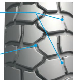
Le motif de bande de roulement entièrement géométrique rainuré (sans côte centrale) est conçu pour fournir une traction sur- et hors-route sans compromis.
