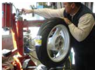
Fig. 5 : Positionnez le pneu non gonflé verticalement.
