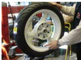
Fig. 5 : Positionnez le pneu non gonflé verticalement.
