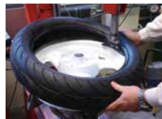
Fig. 2 : Installation du premier bourrelet.
