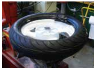
Fig. 3 : Installation du deuxième bourrelet.
