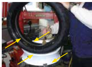
Fig. 1 : Lubrification du pneu et de la jante.
